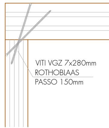
DETTAGLIO COLLEGAMENTO PANNELLI XLAM PARETI LONGITUDINALI - SOLAIO
