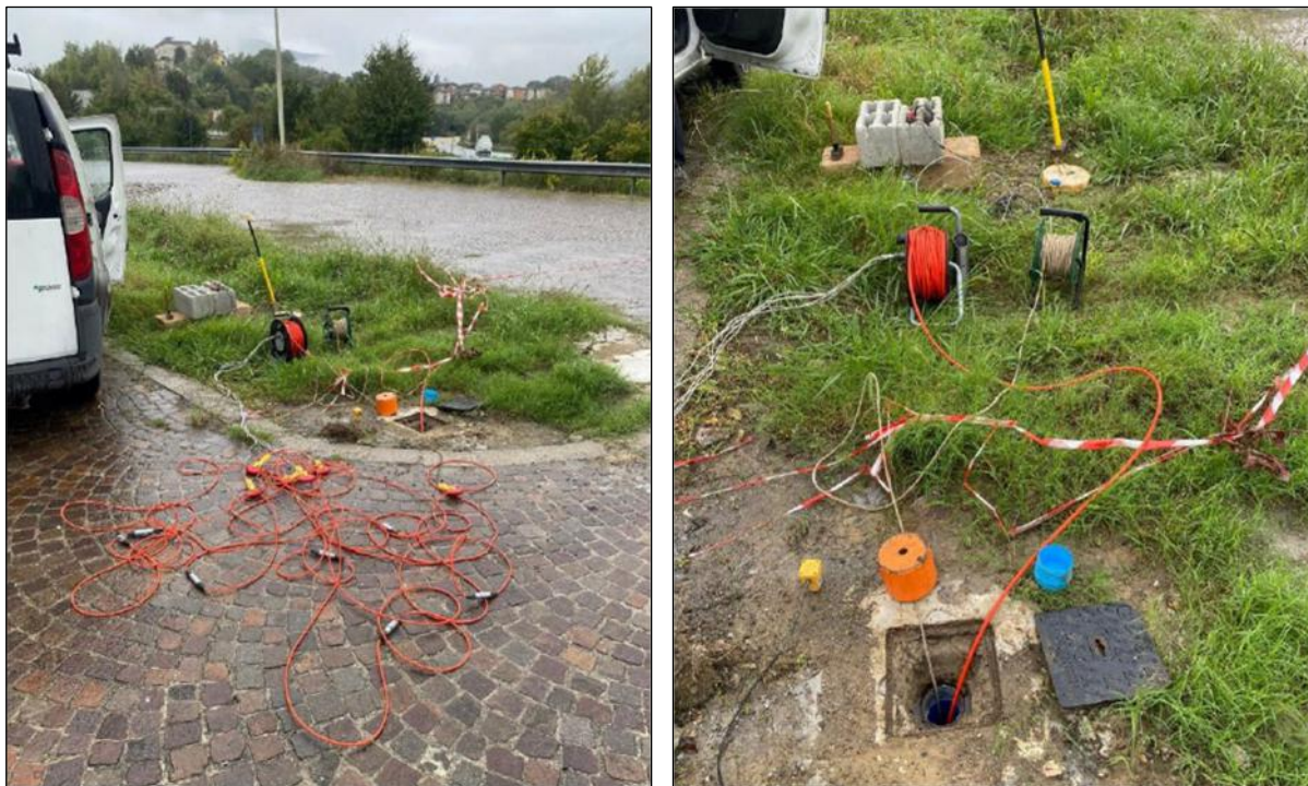
Figura n.12 - Fasi dell'esecuzione della Down-Hole DH; in particolare è possibile mettere in evidenza i sistemi di energizzazione sia delle onde P che delle onde S.
