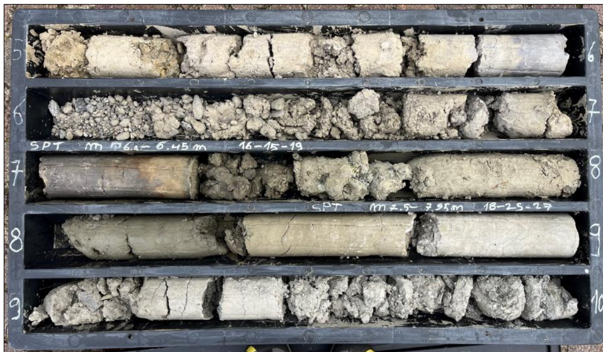
Foto n.2 - Immagine cassetta catalogatrice n.2, sondaggio a carotaggio continuo SCC1 (Profondità da p.c.: 5.0 ÷ 10.0m).
