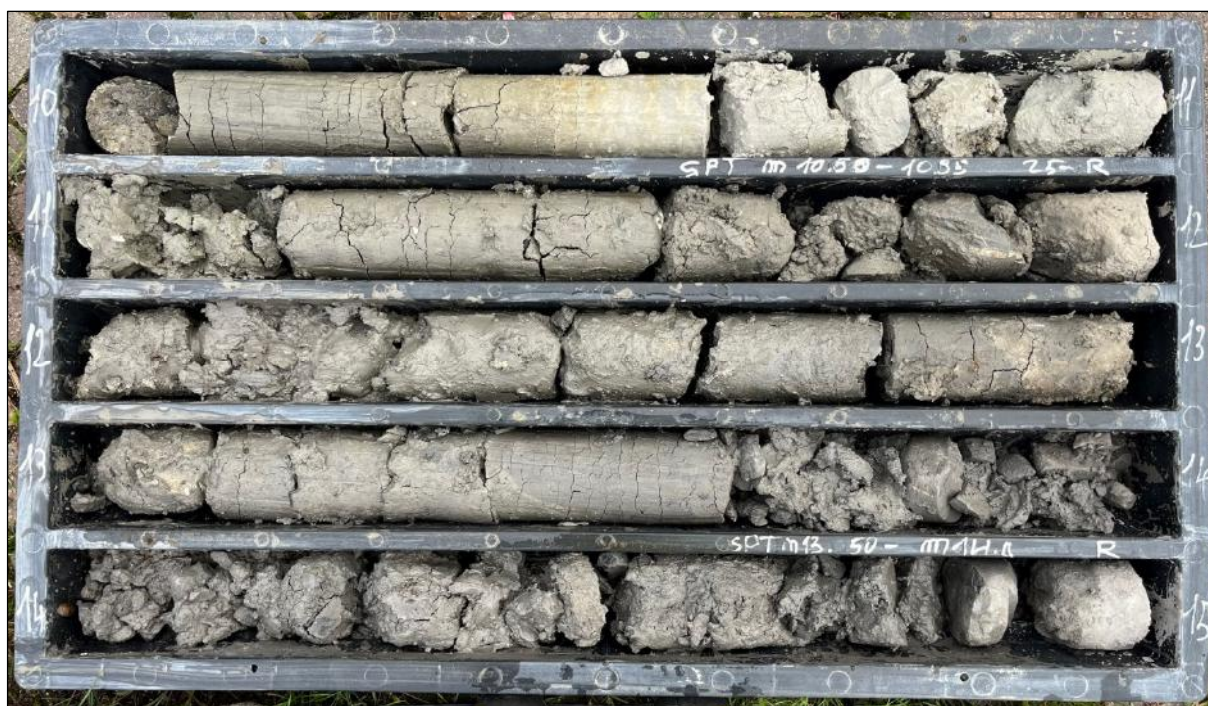
Foto n.3 - Immagine cassetta catalogatrice n.3, sondaggio a carotaggio continuo SCC1 (Profondità da p.c.: 10.0 ÷ 15.0m).
