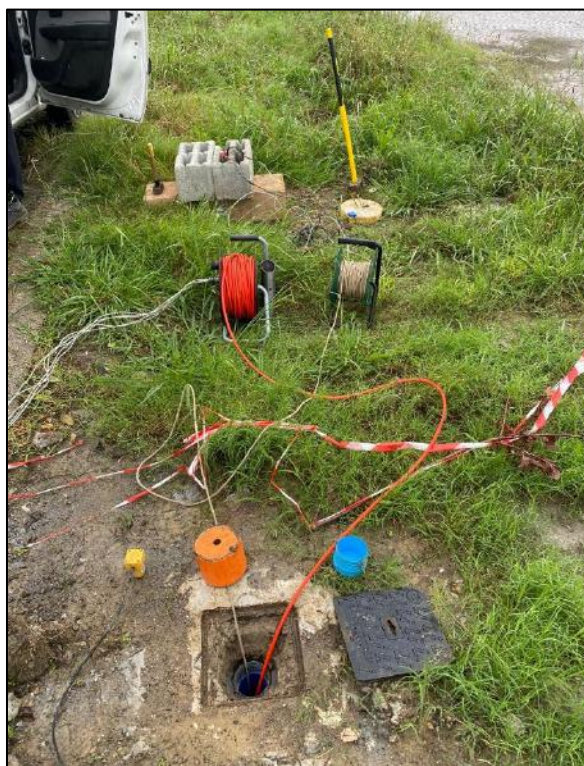
Foto – Indagine sismica attiva Down-Hole (DH)
