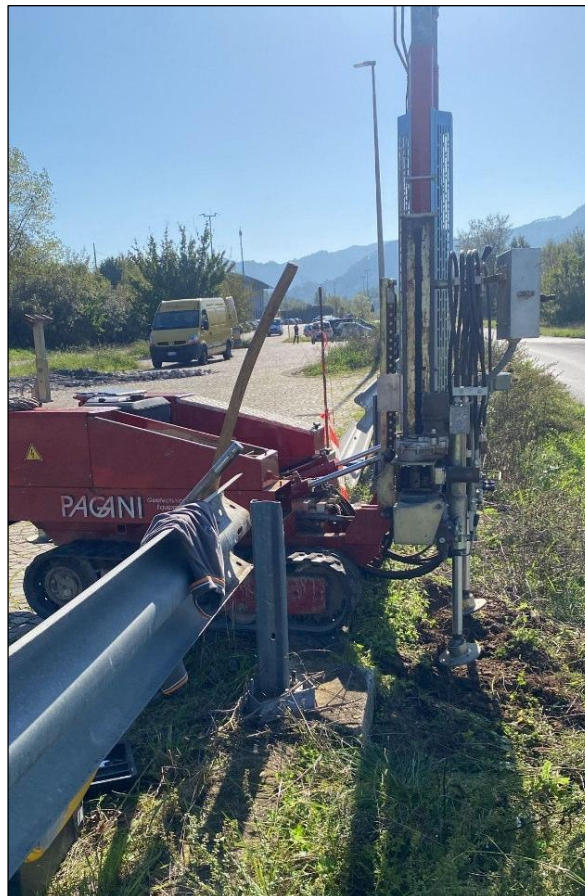
Figura n.23 - Fasi di esecuzione della prova penetrometrica dinamica superpesante DPSH2.
