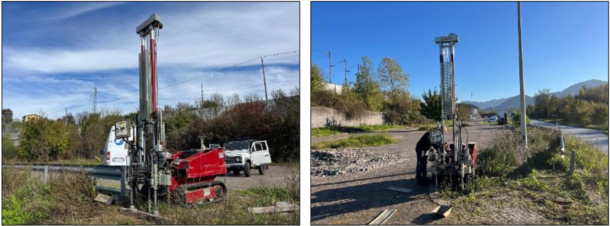
Figura n.22 - Fasi di esecuzione delle prove penetrometriche dinamiche superpesanti DIN1 (a sx) e DIN2 (a dx).
