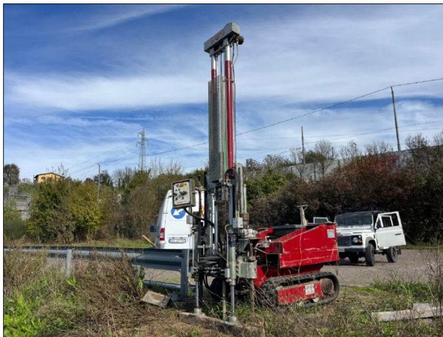
Figura n.21 - Fasi di esecuzione della prova penetrometrica statica CPT1.
