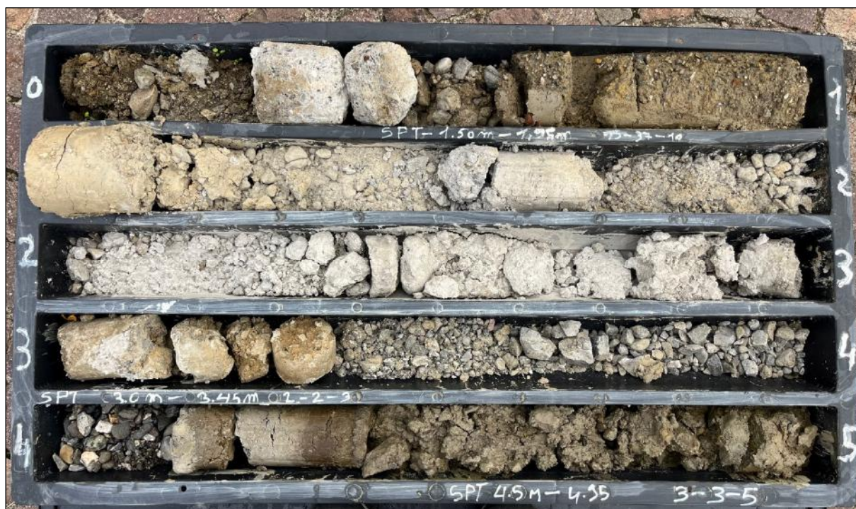
Foto n.1 - Immagine cassetta catalogatrice n.1, sondaggio a carotaggio continuo SCC1 (Profondità da p.c.: 0.0 ÷ 5.0m).
